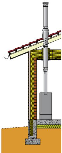
**Состав комплекта:** Переходник Топка-Permeter, шибер, линейные элементы, конус с зонтиком, хомут для перекрытия.
