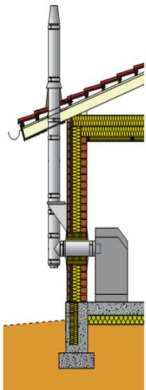
**Состав комплекта:** Промежуточный опорный эл-т, заглушка с отводом конденсата, опорная консоль, тройник 90°, переходник PrimaPlus - PM, линейные элементы, конус с зонтиком, хомут для перекрытия.
