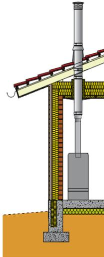
**Состав комплекта:** Переходник Топка-Permeter, шибер, линейные элементы, проход через крышу, уплотнительная манжета от дождя, конус с зонтиком, декоративная пластина, хомут для перекрытия.
