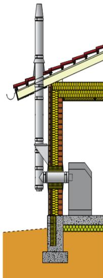
**Состав комплекта:** Промежуточный опорный эл-т, заглушка с отводом конденсата, опорная консоль, тройник 90°, переходник PrimaPlus - PM, линейные элементы, проход через крышу, уплотнительная манжета от дождя, конус с зонтиком, декоративная пластина, хомут для перекрытия.
